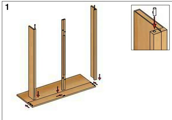
1 Kopfteil flach auf den Boden legen. Seitenteile und Mittelsteg anfädeln und mit Hilfe eines Gummihammers festschlagen. Riegel (A) in die dafür vorgesehenen Öffnungen einlegen (Nase zum Bett- inneren gerichtet)
