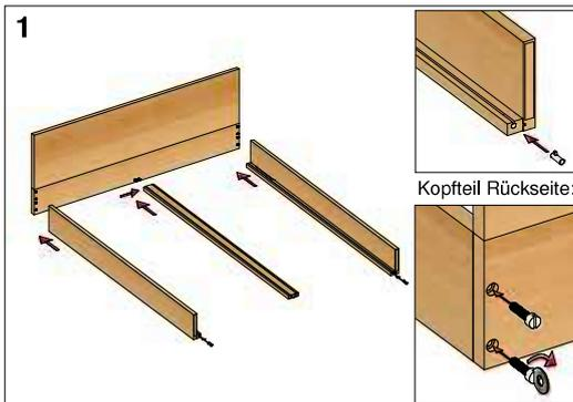
Seitenteile mittels Dübel (C) in Kopfteil einstecken und rückseitig mit Holzschraube (D) festziehen. **ACHTUNG:** Montagehilfe (E) verwenden, um Schraube nicht zu beschädigen!
