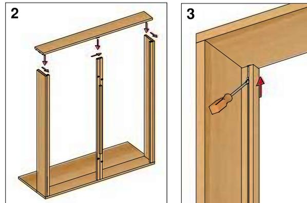
2 Fußteil auf Seitenteile und Mittelsteg auffädeln und festschlagen. Riegel (A) in Fußteil einschieben
